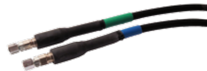
5 Lastsensoren zur Messung des Hebedrucks
